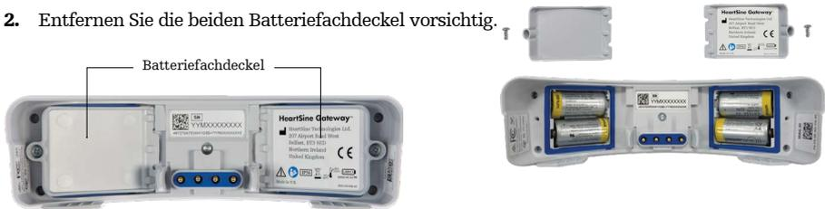
3. Legen Sie die vier mitgelieferten CR123A Batterien ein. Vergewissern Sie sich, dass die Batterien wie im Batteriefach des HeartSine Gateway gezeigt eingelegt sind.
